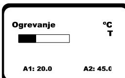
Po tem, ko kazalec (kurzor) zapolni celotno kvadratno polje se zaključi procedura začetnega ogrevanja senzorja in naprava preide v normalen način delovanja.
