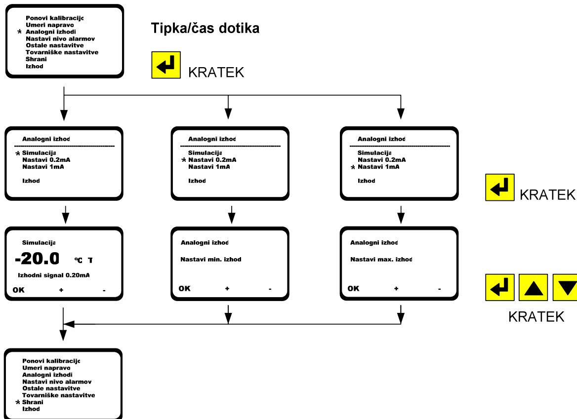
Podmeni >>**Analogni izhodi**<< je namenjen za nastavitev analognega izhodnega signala
