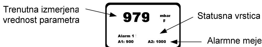
V normalnem načinu delovanja (brez stanja alarmov ali napak) sta na grafičnem LCD prikazovalniku prikazana le trenutna izmerjena vrednost merjenega parametra in obe nastavljeni alarmni meji. Statusna vrstica je v tem primeru prazna, lokalna LED indikatorja pa sta neaktivna.
