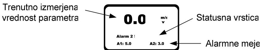
V normalnem načinu delovanja (brez stanja alarmov ali napak) sta na grafičnem LCD prikazovalniku prikazana le trenutna izmerjena vrednost merjenega parametra in obe nastavljeni alarmni meji. Statusna vrstica je v tem primeru prazna, lokalna LED indikator pa sta neaktivna.
