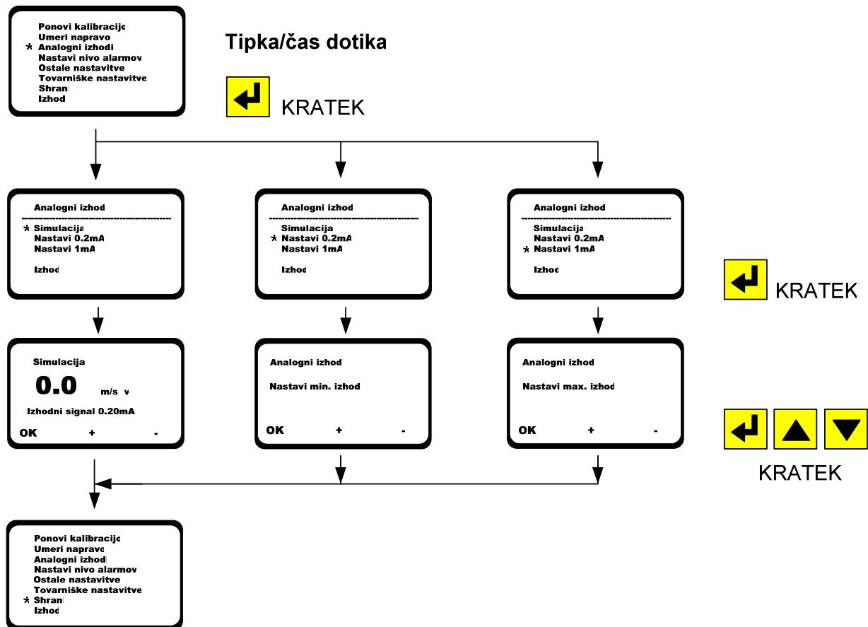
Meni >>**Analogni izhod**<< je namenjen za nastavitev analognih izhodnih parametrov.
