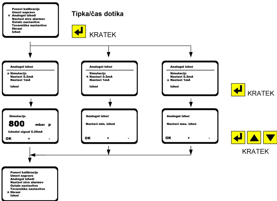
Meni **Analogni izhod** je namenjen za nastavitve analognih izhodnih parametrov.
